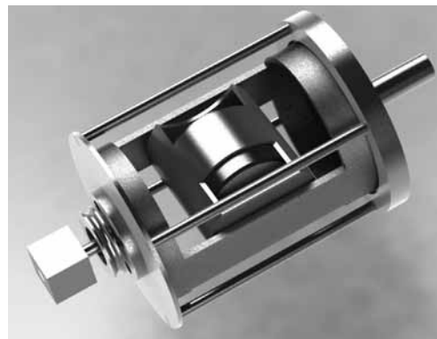
Рис. 3. Модель в сборе с гироскопическим стабилизатором
