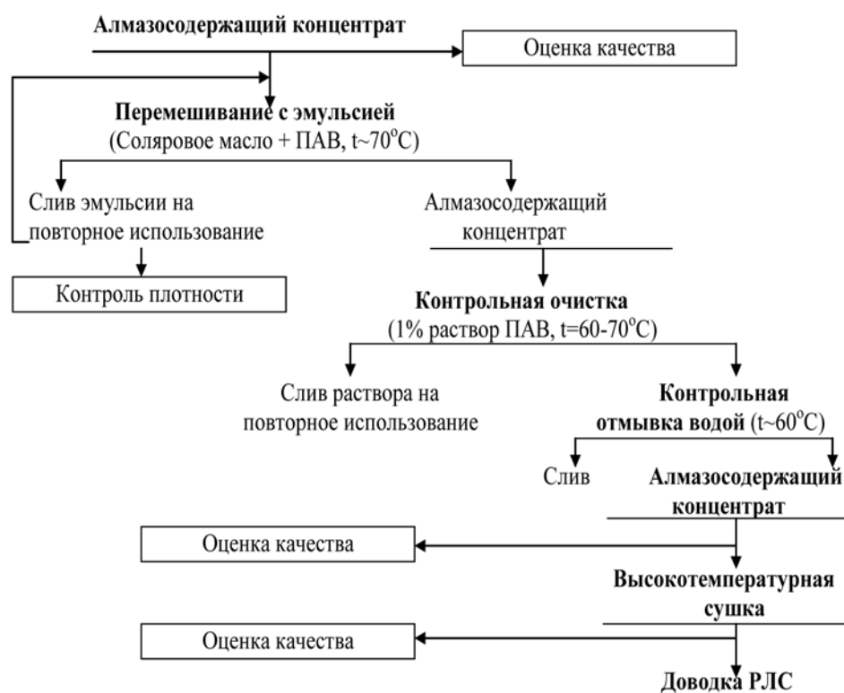
Рис. 1. Принципиальная схема отмывки алмазосодержащих концентратов с использованием водоземulsionной технологии
