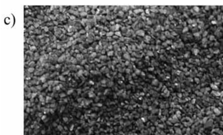
2. Концентрат пенной сепарации, отмытый с применением эмульсионного метода
