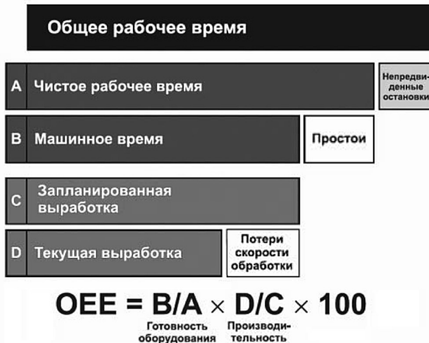
Рис. 1. Диаграмма составляющих показателя эффективности оборудования и формула показателя эффективности оборудования
