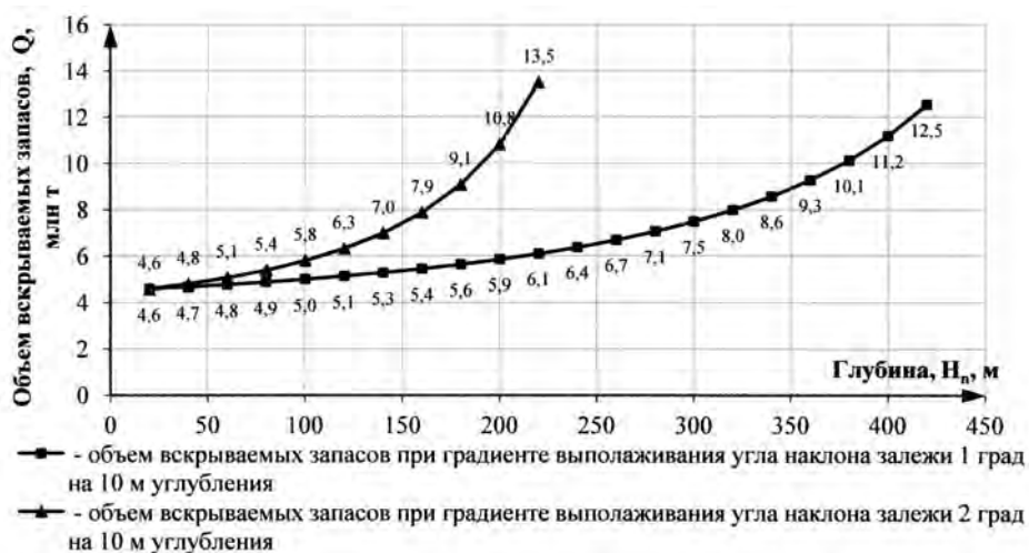
Рис. 2. Изменение объемов вскрываемых запасов угля с глубиной карьера при различных градиентах выполаживания для залежи с углом наклона от 40 до 0 град (начальная длина добычного фронта 6000 м, а конечная – 5570 м)
