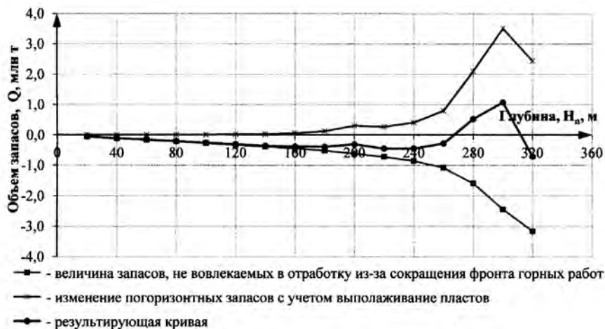
Рис. 6. Погоризонтное изменение объемов запасов, показывающее долю влияния отрицательного фактора и положительного для крутого крыла Соколовской брахисинклинали (углы наклона пластов изменяются от 74 до 0 град)
