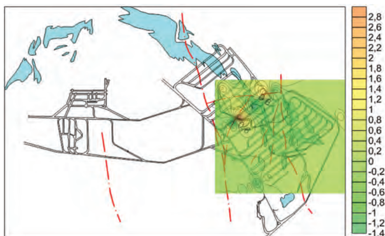
Рис. 7. Деформации в массиве на гор. -350 м (16.07.2014)
