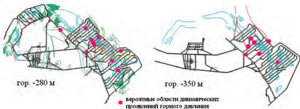
Рис. 9. Наиболее вероятные области динамических проявлений горного давления на горизонтах: а – (-210 м), б – (-280 м), в – (-350 м)
