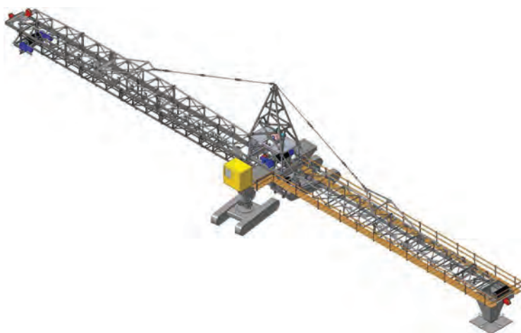
Рис. 1. Перегрузатель ленточный телескопический (П/ЛТ)
