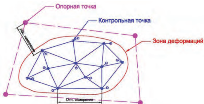
Рис. 13. Классическая концепция деформационной сети с неподвижными опорными и подвижными контрольными точками
