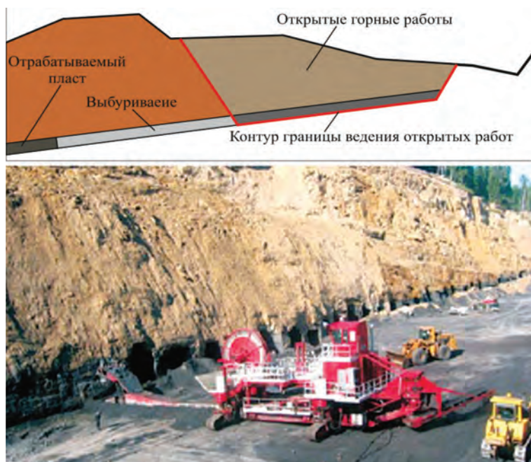
Рис. 11. Общий вид комплекса КГРП и схема выемки угля
