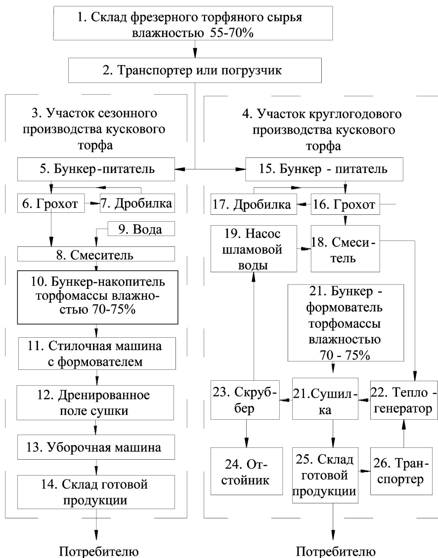
Рис. 1. Схема технологической линии комплекса по производству кускового топливного торфа
