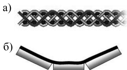
Рис. 4. Тканевое двойное плетение кордной ткани типа ЕРР, и ее взаимодействие с линейной роликоопорой: а) конструкция двойного тканевого плетения, б) взаимодействие ленты двойного тканевого плетения типа ЕРР с роликоопорой
