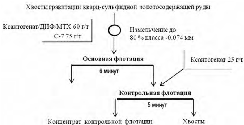
Рис. 7. Схема и реагентный режим флотации хвостов гравитации
