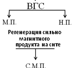
Рис. 2. Схема выделения гидроокислов
