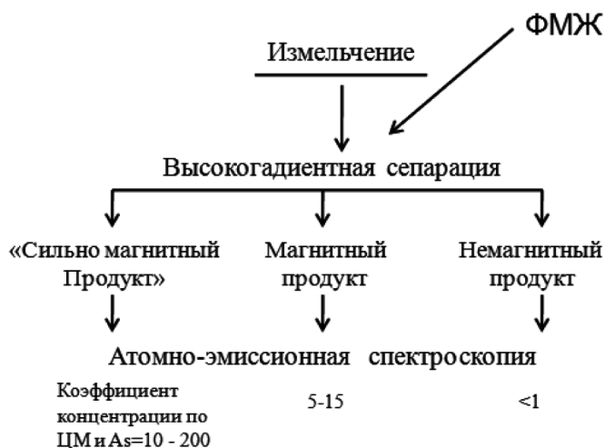
Рис. 7. Полная схема анализа геохимических проб, на содержание подвижных форм химических элементов
