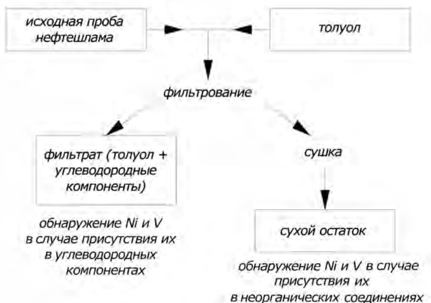
Рис. 14. Схема распределения никеля и ванадия в фазах нефтяного шлама
