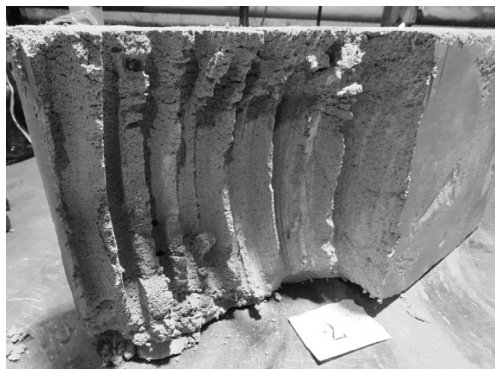
Рис. 2. Общий вид оставшихся целичков породы после разрушения блока рабочим органом
