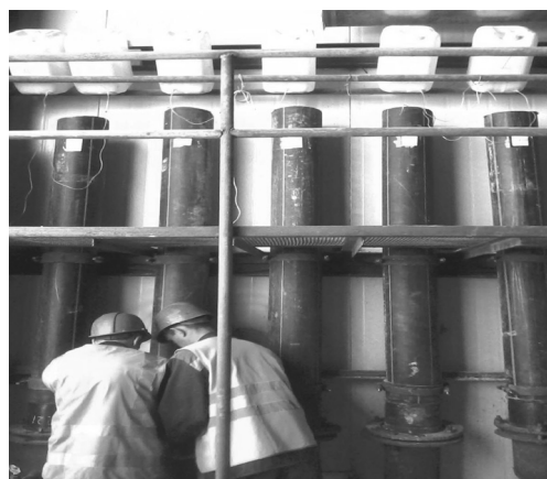
Рис. 5. Фото перколяторов, изготовленных на руднике ЗАО «Апрельково»
