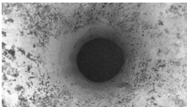
Рис. 3. Агломерированная руда в перколяторе
