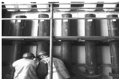
Рис. 2. Перколяторы для моделирования кучного выщелачивания на руднике Апрельково
