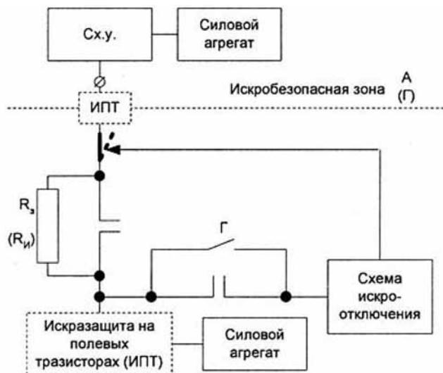
Рис. 12. Оценочный измерительный резистор по Сотскому с учетом брюка тока включения (переходные контакты)
