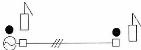
Рис. 7. Схема электроснабжения от ДЭС с групповым присоединением потребителей с печным отоплением
