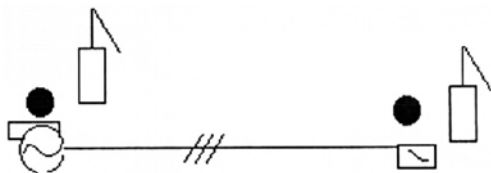
Рис. 6. Схема электроснабжения от ДЭС с групповым присоединением потребителей с утилизатором тепла на один станок, к другому станку передается только электроэнергия как на технологические нужды так и на обогрев
