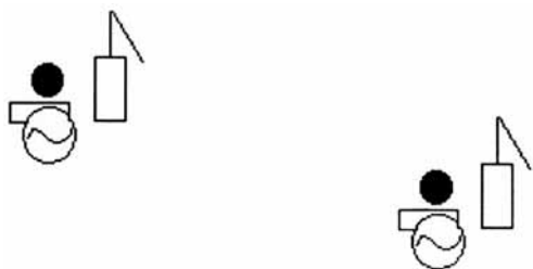
Рис. 4. Схема электроснабжения от индивидуальных ДЭС с утилизацией тепла с индивидуальными теплообменниками
