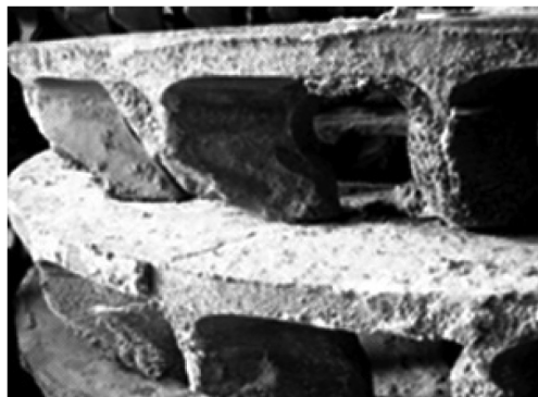
Рис. 2. Нарботка чугунного импеллера 720 часов
