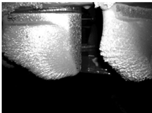
Рис. 3. Нарботка импеллера, облицованного полиуретаном, 4605 часов
