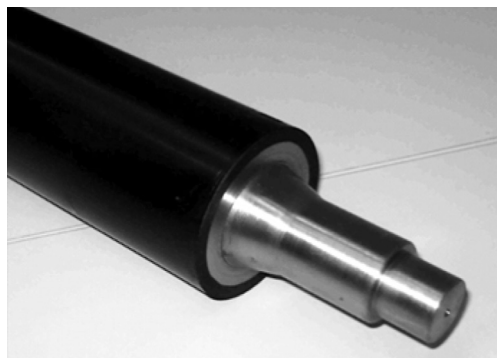
Рис. 1. Ролик роликового питателя, изготовленный из черного металла и облицованный полиуретаном марки АБРАЗИВЭЛАСТ®
