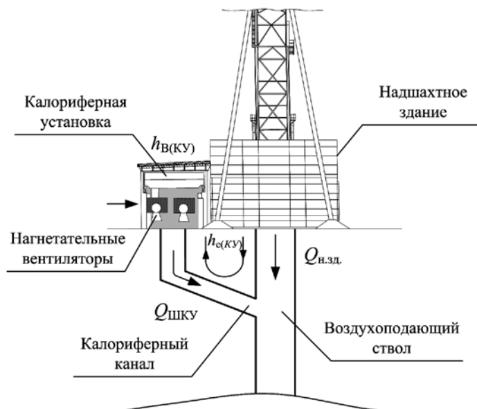
Рис. 2. Возникновение тепловой депрессии при работе калориферной установки
