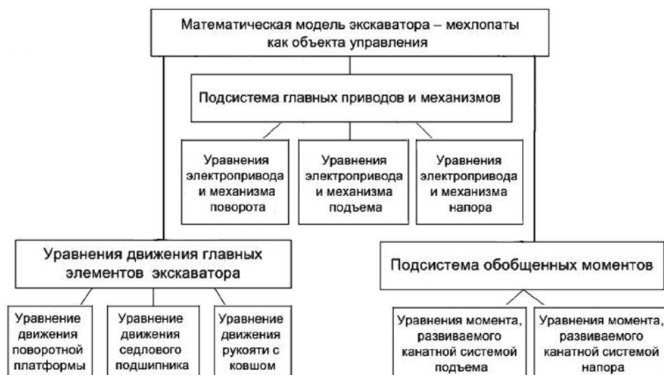
Рис. 1. Структура математической модели экскаватора-мехлопаты
