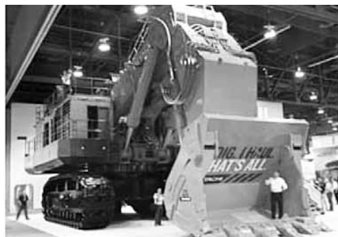
Рис. 13. Карьерная прямая гидравлическая лопата EX 8000-6 компании Hitachi
