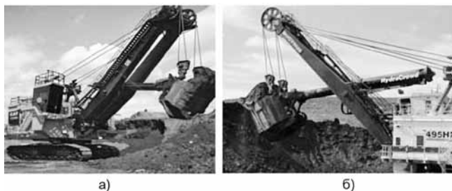
Рис. 6. Карьерные механические лопаты 7495 компании Сат с напорными механизмами: а – канатным; б – гидравлическим «HydraCrowd»
