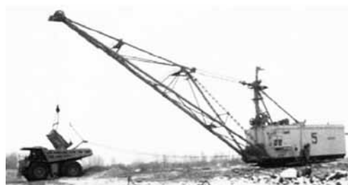
Рис. 22. Шагающий экскаватор НКМЗ ЭШ-6,5/45 при погрузке в автотранспорт
