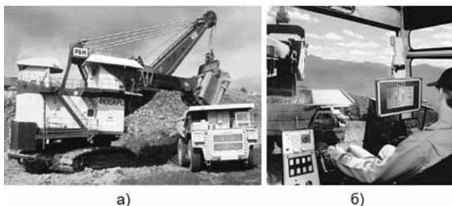
Рис. 7. Карьерная механическая лопата с речным напором: а) – 4100ХРС; б) – кабина машиниста с графическим интерфейсом управления компании Р&Н
