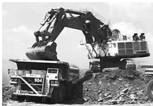
Рис. 12. Карьерная обратная гидравлическая лопата R 9800 с ковшом 45 м 3 компании «Liebherr» на разрезе Burton, Австралия
