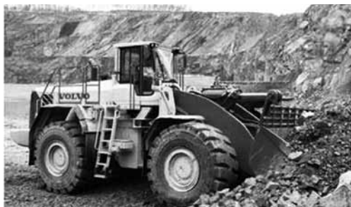
Рис. 19. Колесный фронтальный погрузчик L350F компании «Volvo» с ковшем 12,7 м 3
