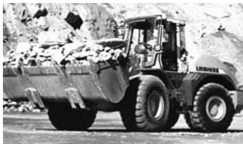
Рис. 20. Колесный фронтальный погрузчик L-586 с ковшем 5,5 м 3 компании «Liebherr»
