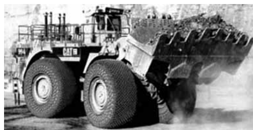
Рис. 16. Колесный фронтальный погрузчик 994K с ковшом 24 м 3 компании Caterpillar
