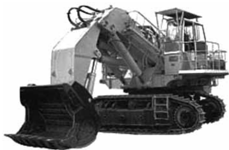
Рис. 14. Карьерная гидравлическая лопата ЭГ-110 ИЗ «КАРТЭКС»
