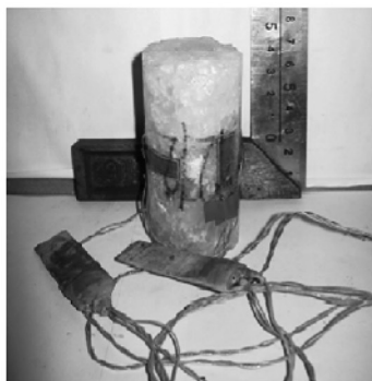
Рис. 2. Схема формирования мостового соединения на примере образца 112/2 (Рассошенская площадь) с приклеенными и распаянными тензорезисторами
