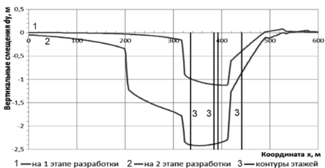
Рис. 4. Профиль вертикальных смещений \delta_y земной поверхности в результате выемки пласта V9b(44b) без закладки выработанного пространства этажей
