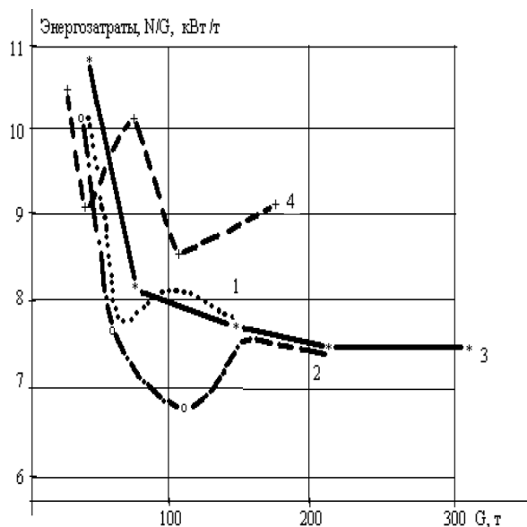
Рис. 2. Изменение энергозатрат на единицу грузоподъемности автосамосвала в зависимости от его грузоподъемности: 1 – фирма «Юклид», 2 – «Вабко», 3 – «Терекс», 4 – БелАЗ
