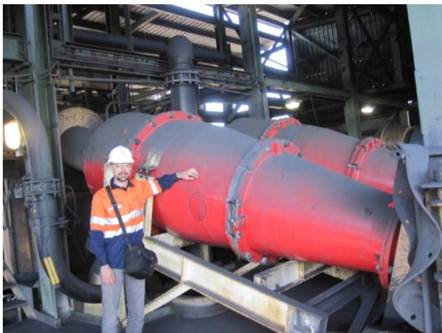
**Фотографии тяжелосредных гидроциклонов большого диаметра на обогатительных фабриках в Австралии**
