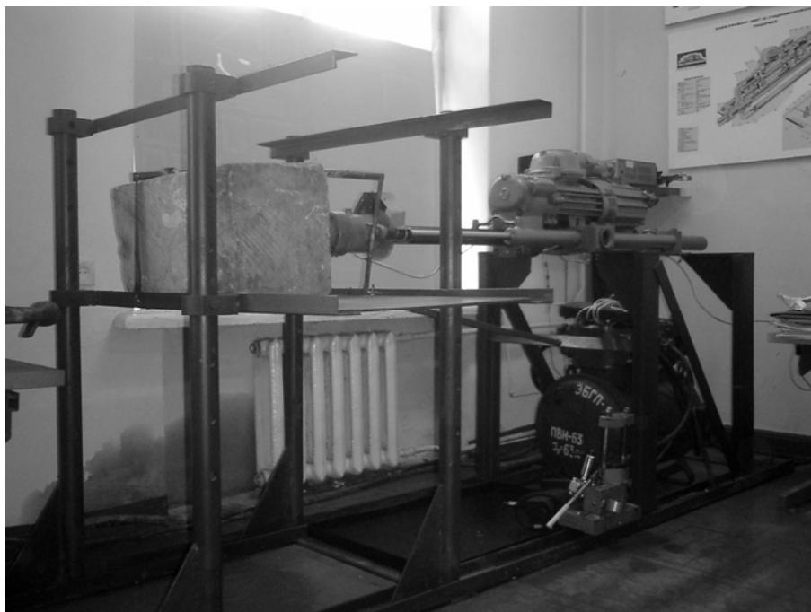
**Рис. 2. Модернизированная адаптивная бурильная машина на базе электрогидравлического бура ЭБГП-1 в лабораторных условиях в момент проведения экспериментов**
