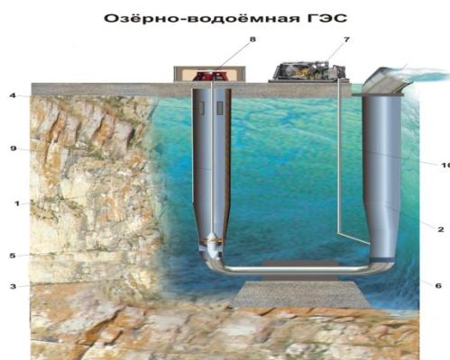
Озерно-водоемная ГЭС (Инновационный патент РК по заявке №2013/0063.1 от 24.01.2013) содержит два вертикальных ствола 1 и 2 соединенных дугообразной перемычкой 3, причем, в верхней части первого ствола 1 расположены заслонки 4, а в его нижней части гидротурбина 5, невозвратный клапан 6, расположенный в нижней части второго ствола 2, пневмтурбину (компрессор) 7, гид-
