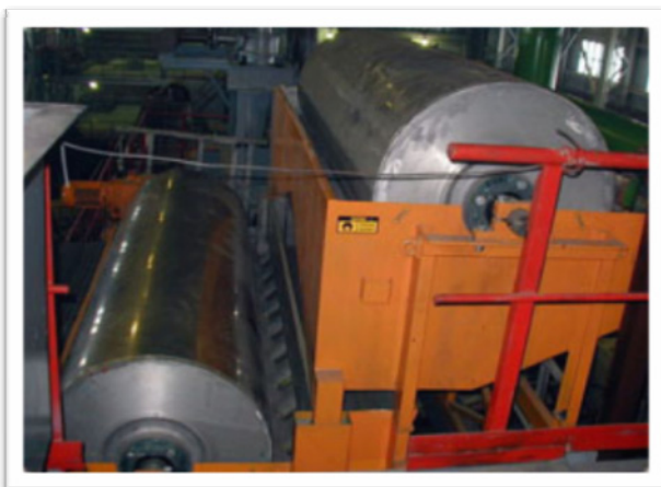
Рис. 1. Двухбарабанный магнитный сепаратор фирмы «Eriez» (США) для регенерации магнетита
