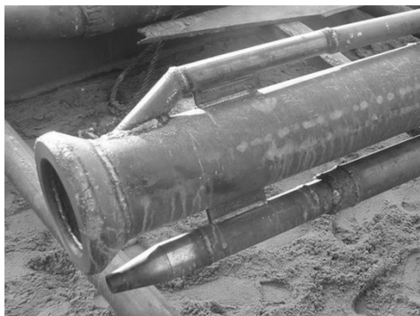
Рис. 1. Скважинные гидродобычные снаряды::
