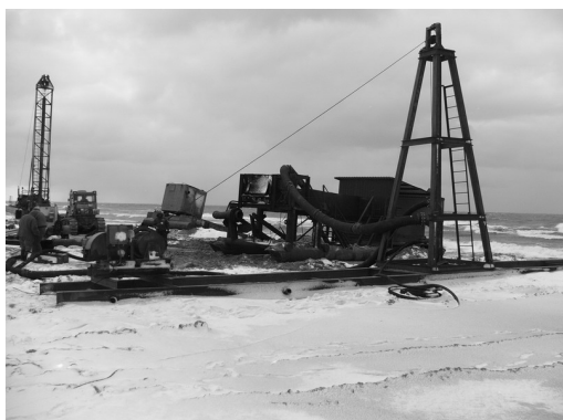
Рис.2. Предохранительный настил с лебедкой и мачтой для управления гидродобычным снарядом
