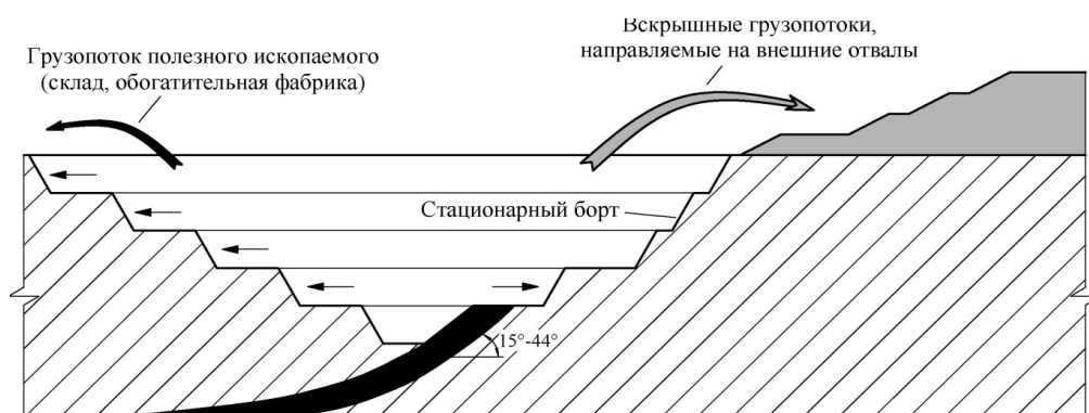
Рис. 2. Отработка средней зоны брахисинклинали с наклонным падением пластов
