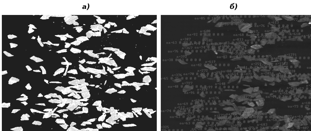
Рис. 4. Оценка площади, занимаемой минералами с цветовой характеристикой родохрозитовой разности в родохрозитовых кусках: а) качественная оценка (белый цвет - с цветовой характеристикой родохрозита, зеленый – с цветовой характеристикой манганокальцита); б) количественная оценка (первая цифра обозначает площадь, занимаемую минералами с цветовой характеристикой родохрозита, третья цифра обозначает площадь, занимаемую минералами с цветовой характеристикой манганокальцита)
