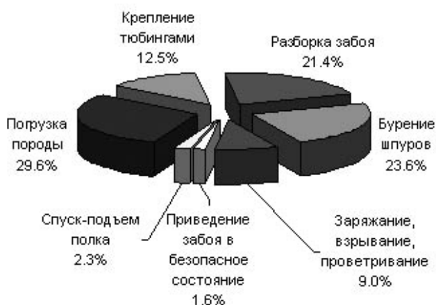
Рис. 2. Структура затрат времени на выполнение отдельных процессов проходческого цикла
