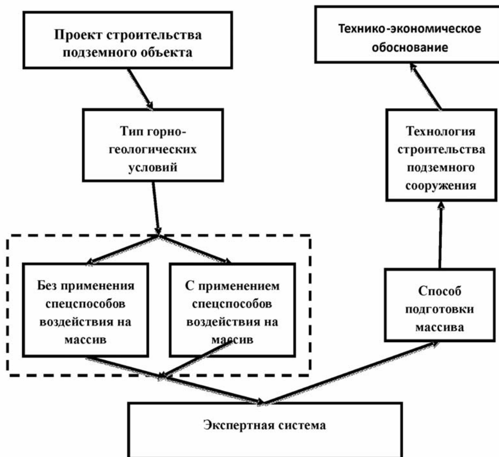
Рис. 2. Блок-схема проектирования подземного сооружения
