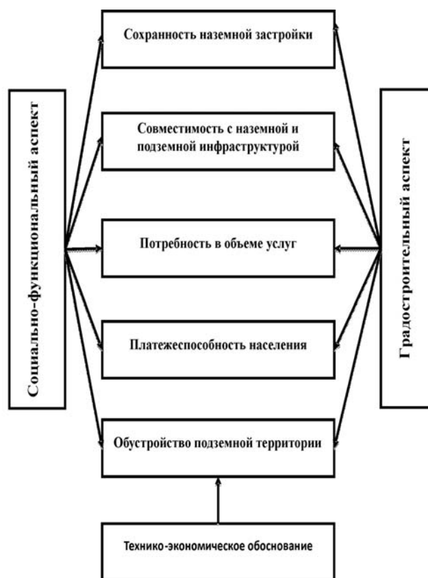
Рис. 1. Градостроительные и социально-функциональные требования при проектировании подземных сооружений
