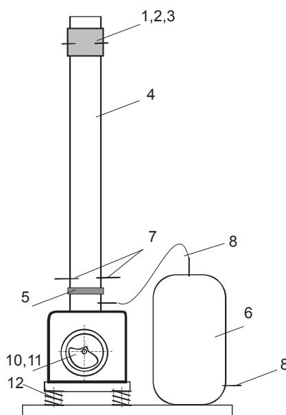
**Опытная установка для исследования пирофорности аэровзвесей ВВ:** 1, 2 — штифты для фиксации фильтра, 3 — войлочный фильтр, 4 — камера установки, 5 — подина из губчатого железа, 6 — ресивер, 7 — электроды, 8 — воздуховод, 9 — дебаланс, 10 — маховик, 11 — основание установки, 12 — виброопоры
