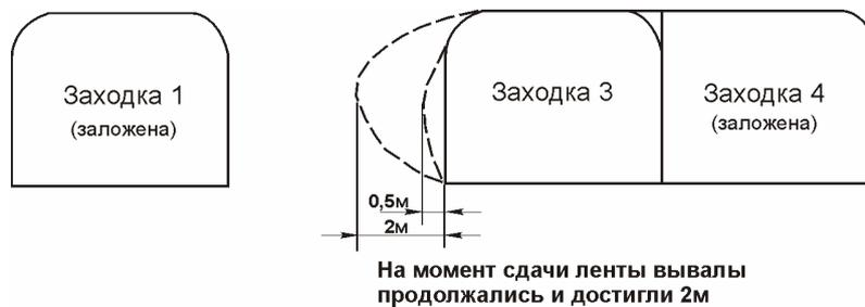
**Рис. 5. Разрушения в левом борту заходки 3 по данным визуальных наблюдений**
