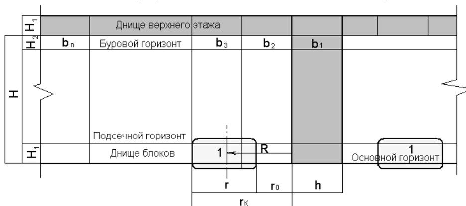
**Рис. 4. Схема расположения зон концентрации динамических явлений (1).  $b_1$  – разрезной блок в этаже;  $b_n$  – обрабатываемые блоки;  $n$  – номер блока;  $h$  – ширина блока;  $R$  – расстояние от выработанного пространства до центра зоны концентрации динамических явлений;  $r$  – ширина зоны;  $r_0$ ,  $r_k$  – границы зоны концентрации динамических явлений;  $H$  – высота этажа;  $H_1$  – высота днища блока;  $H_2$  – высота бурового горизонта**
