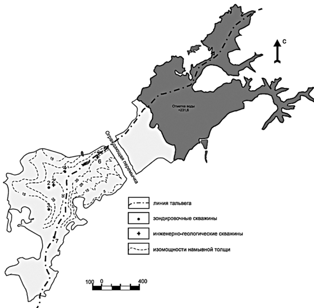
Рис. 3. Инженерно-геологическая сеть опробования с распределенной плотностью гидроотвала № 3 Кедровского угольного разреза
