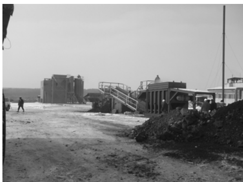
Рис. 5. Комплекс ДСКА производительностью 300 т/час для дробления угля (с обеспечением выгодной структуры рассева) для установки пневматического обогащения производства КНР (ШУ «Липовецкое» ОАО «СУЭК»)
