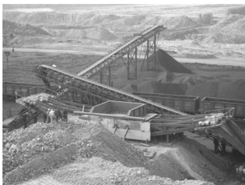
Рис. 1. Конструкция комплекса ДСКА производительностью 1500 т/час в варианте поставки ОАО «Переяславский разрез» (г. Красноярск)
