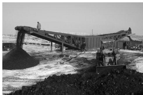
Рис. 2. Конструкция комплекса ДСКА производительностью 750 т/час в варианте поставки ООО «Каражыра» (Республика Казахстан)
