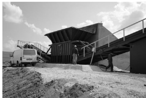
Рис. 4. Конструкция комплекса ДСКА производительностью 600 т/час для одностадийного дробления (до фракции 0-25 мм) и сортировки лигнита в варианте поставки компании «Bitola» (Республика Македония)
