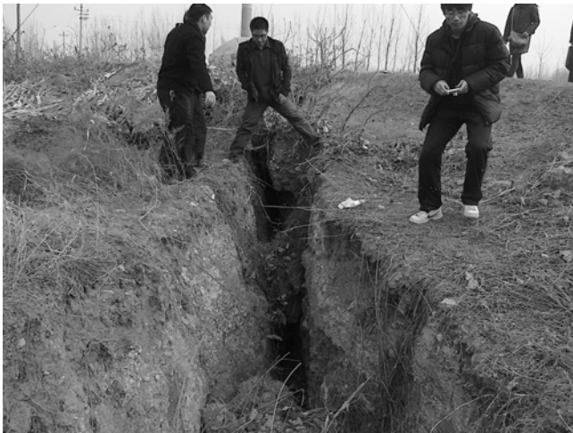
Рис. 1. Фрагмент трещины на поверхности шахтного поля
