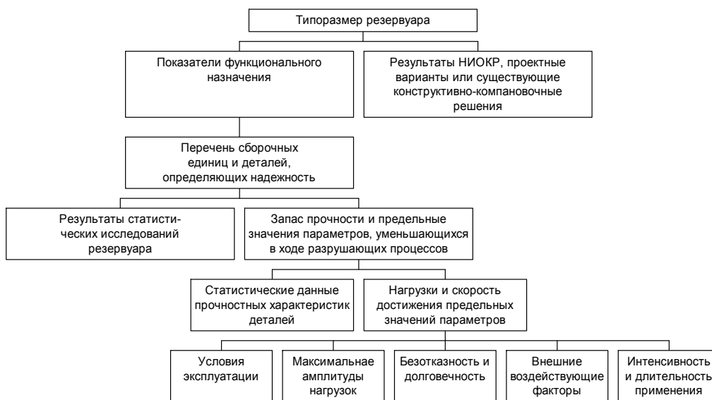
Рис. 2. Структура формирования опорного уровня надежности резервуара
