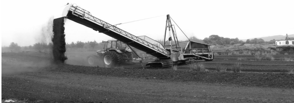
Рис. 4. Уборка фрезерного торфа перевалочными машинами (Bord na Mona, Ирландия)
