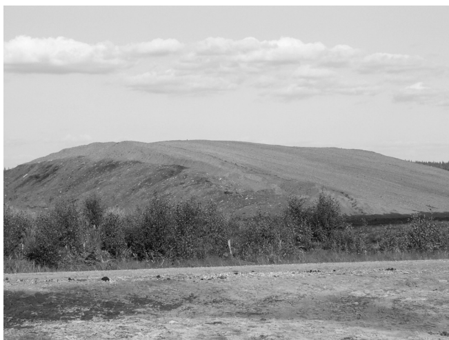
Рис. 3. Крупная складочная единица (штабель) фрезерного торфа (фирма VAPO OY)
