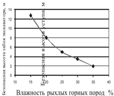
**Рис. 4.** Зависимость безопасной высоты забоя экскаватора от влажности рыхлых горных пород
