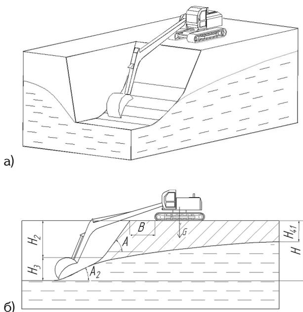
**Рис. 1** Компьютерное моделирование процессов, происходящих в добычномзабое, при ведении горных работ экскаватором «обратная лопата»: а) 3D-модель; б) 2D-модель.
