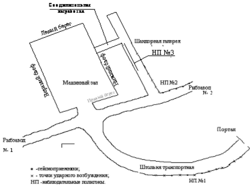
**Рис. 1. Схема подземных выработок ГЭС**
