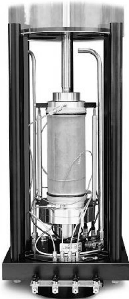
**Рис. 4. Стабилометр для испытаний почв и дорожных покрытий MTS 655.05**
