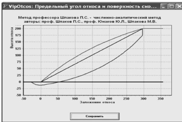
Рис. 10. Построение предельного откоса и поверхности скольжения
