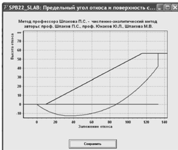
Рис. 17. Построение предельного откоса и поверхности скольжения
