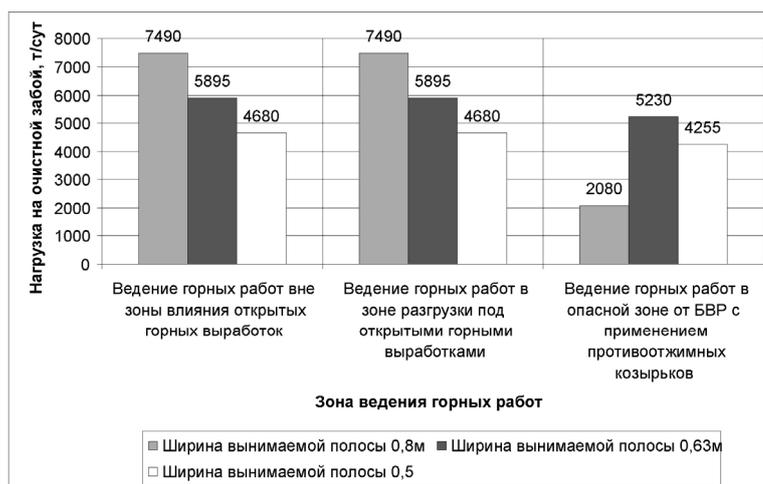
**Рис. 3. Диаграмма нагрузок на очистной забой при ведении горных работ в приконтурной зоне разреза**
