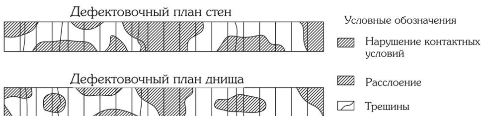
Рис. 5. Распределение внутренних дефектов в обделке
