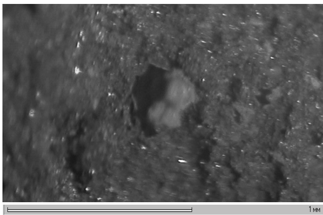
Рис. 3. Частичное выполнение поры сульфатами железа
