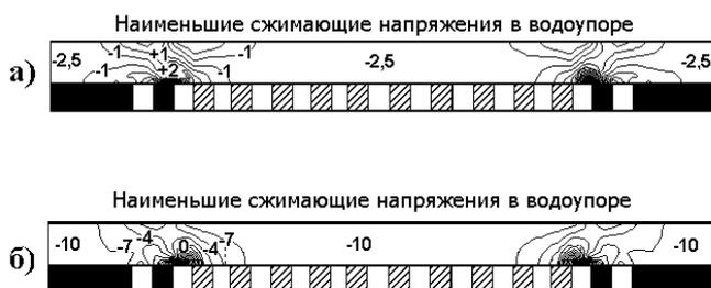
**Рис. 3. Распределение наименьших сжимающих напряжений в водоупоре при соотношении упругих и пластичных целиков 0,2:** (а) – схема заданных смещений; (б) условия «гидростатики» исходных напряжений
