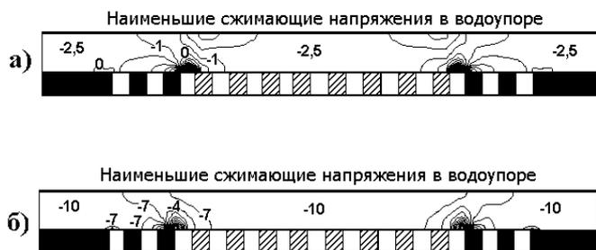
**Рис. 2. Распределение наименьших сжимающих напряжений в водоупоре при соотношении 0,6 упругих целиков (показаны черным цветом) к пластичным целикам (показаны штриховкой):** (а) – схема заданных смещений; (б) условия «гидростатики» исходных напряжений
