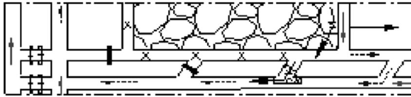
**Рис. 1. Изолированный отвод МВС за счет общешахтной депрессии по неконтролируемой выработке на заднюю сбойку при нисходящем порядке отработки**
